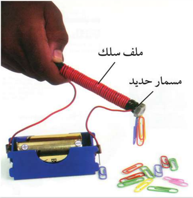
شكل (٢٦): تنجذب المشابك المعدنية للمغناطيس عند غلق الدائرة الكهربائية.
